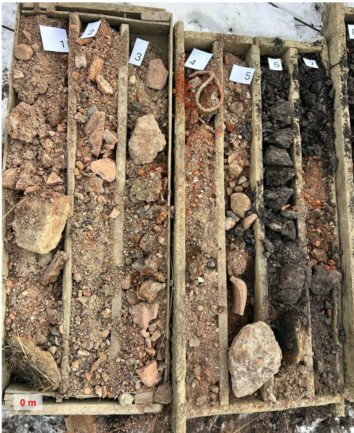
Obrázek 11 Profil jádrově vrtaného průzkumného vrtu J1 (0 – 7 m p. t.), 12. 1. 2026.
