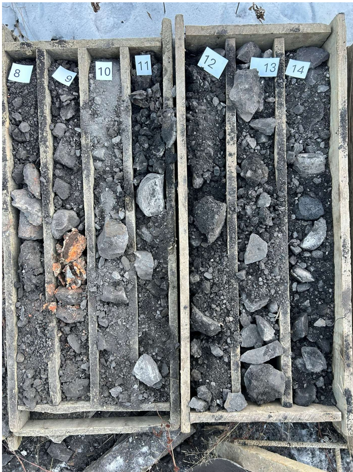
Obrázek 12 Profil jádrově vrtaného průzkumného vrtu J1 (8 – 14 m p. t.), 12. 1. 2026.
