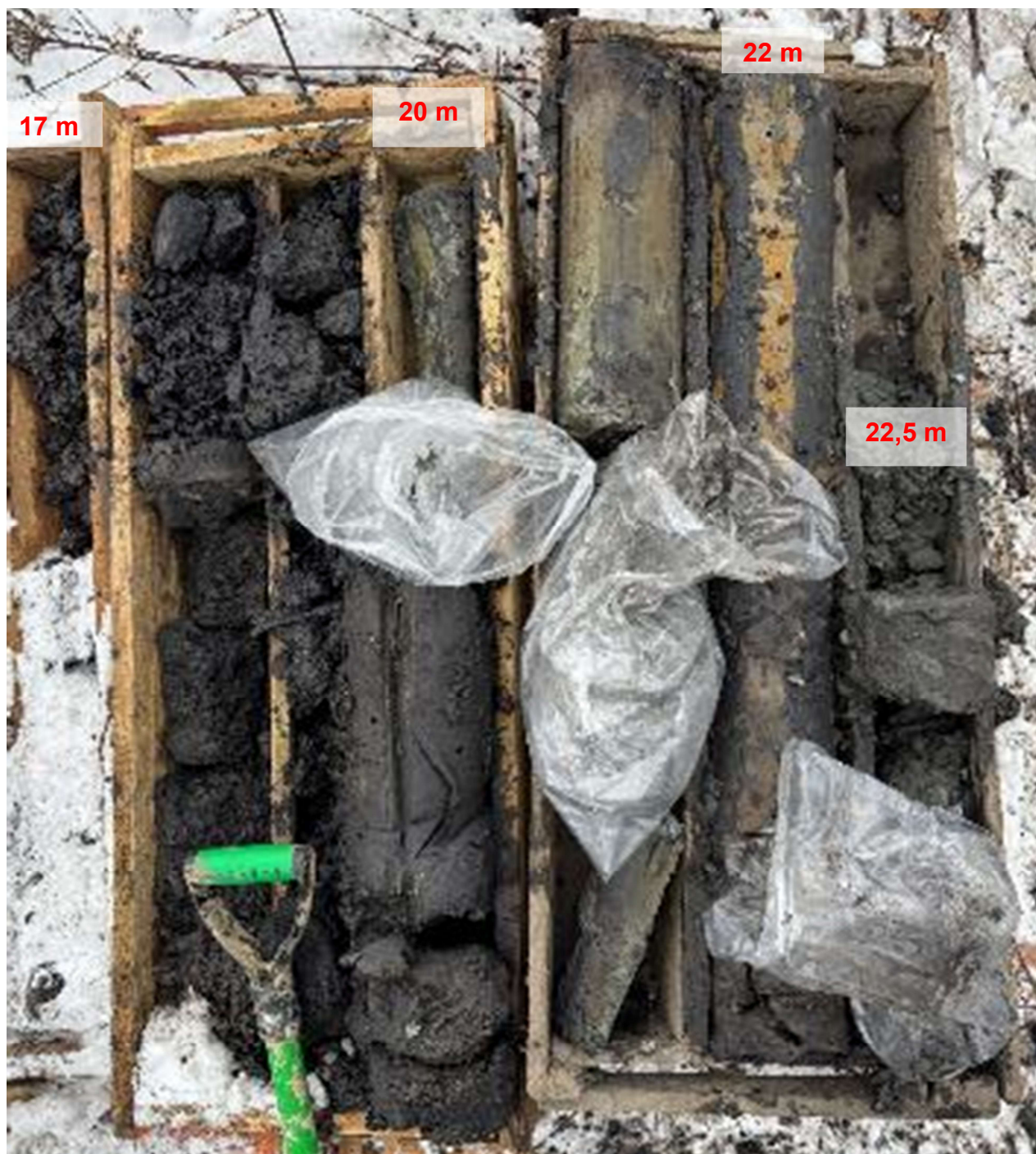
Obrázek 14 Profil jádrově vrtaného průzkumného vrtu J1 (16,5 – 22,5 m p. t.), 13. 1. 2026.
