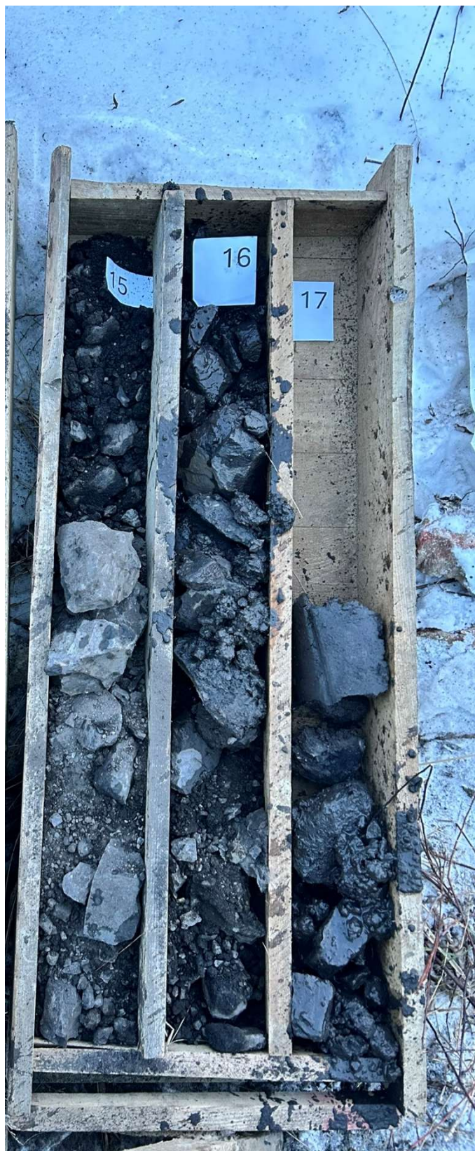
Obrázek 13 Profil jádrově vrtaného průzkumného vrtu J1 (15 – 16,5 m p. t.), 12. 1. 2026.
