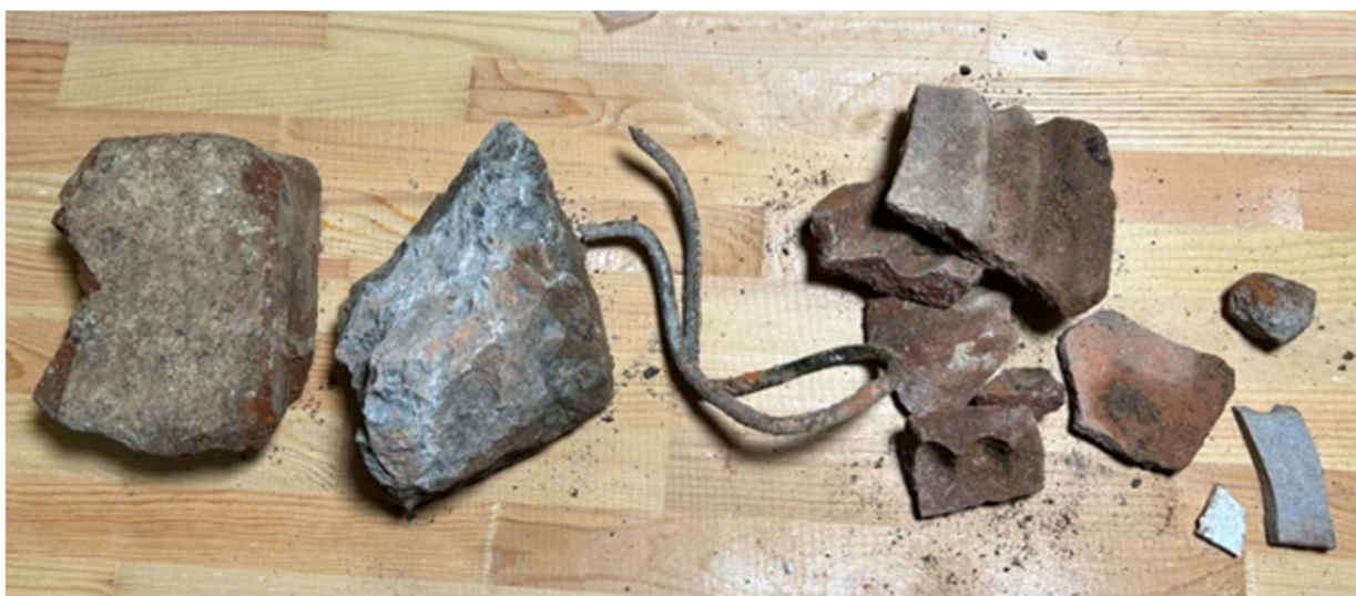
Obrázek 10 Cizorodé částice v antropogenní navážce – stavební suti ve vrtu J1 (0,05 – 5,2 m p. t.).
