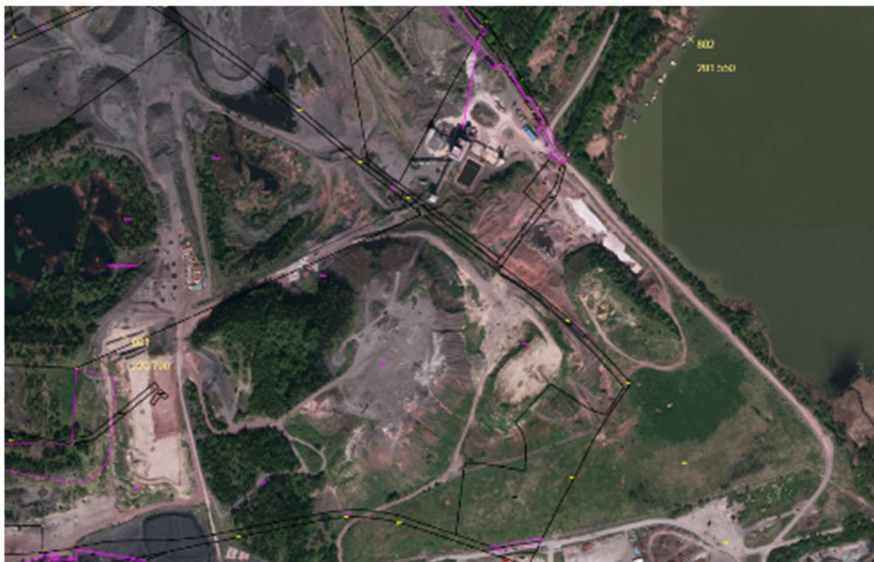
Obrázek 5 Situace geodetického zaměření průzkumného objektu J1 - v situaci označeno bodem 801 a úroveň hladiny vody v Heřmanickém rybníku - v situaci označeno bodem 802 v k. ú. Hrušov, na podkladu katastrální mapy, Gepix, s.r.o., leden 2026
