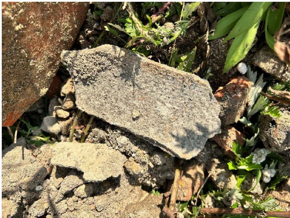
Obrázek 21 Potenciálně rizikové (azbest) úlomky stavební sutě v KS
