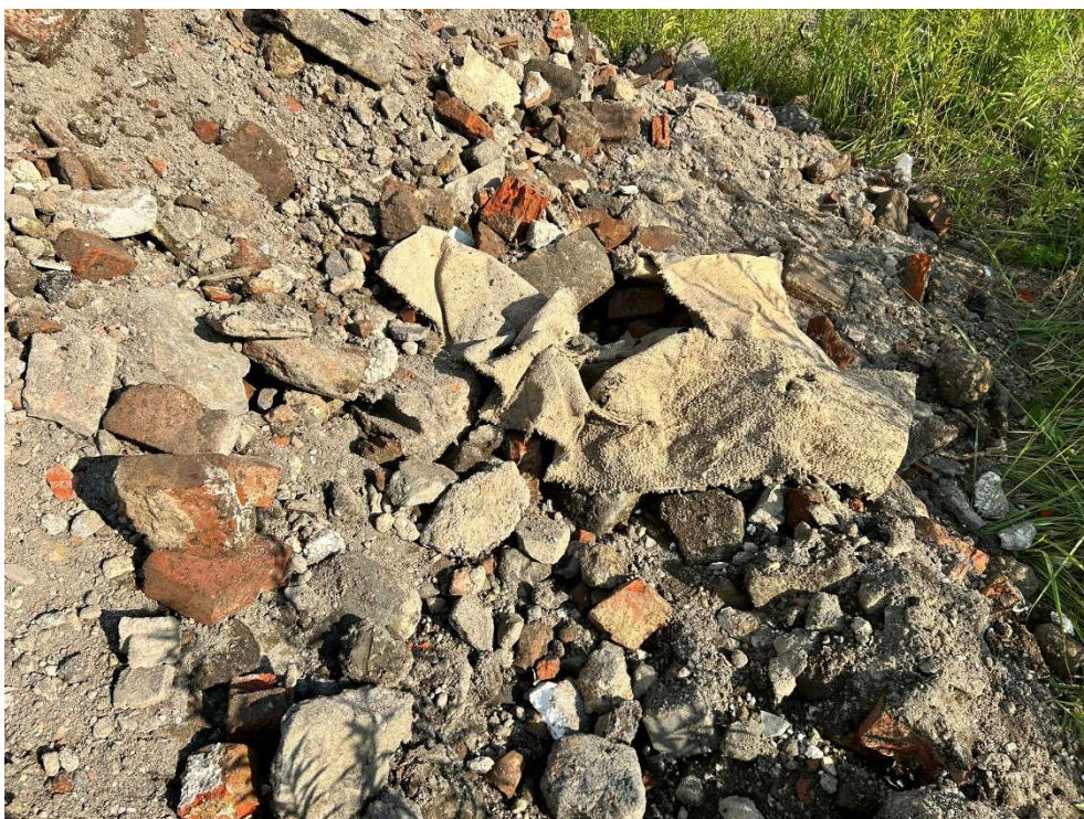
Obrázek 20 Koberce ve stavební suti v KS
