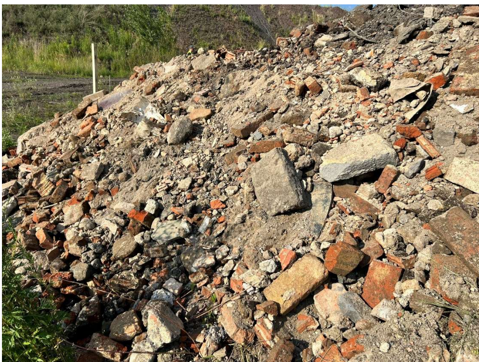
Obrázek 22 Kusy plynosilikátových cihel ve stavební sutí v KS
