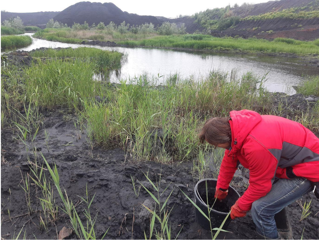
Obrázek 2: Homogenizace dílčích vzorků shromážděných v odběrové nádobě
