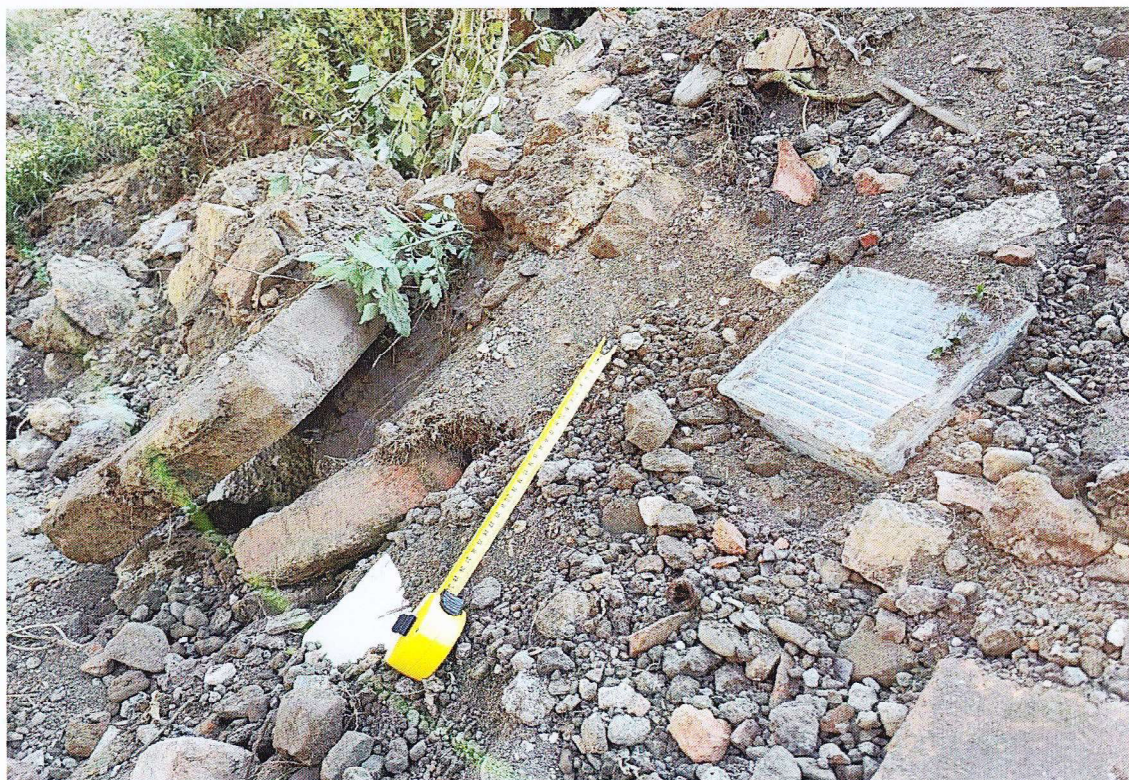
Obr. 7: Materiál z kontrolní kopané sondy (M 30cm)
