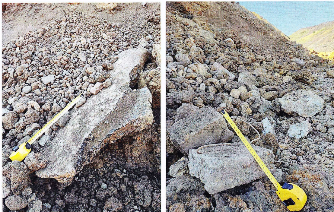
Obr. 10: Stavební odpad v certifikované recyklované zemině frakce 0-90mm (M 30cm)
