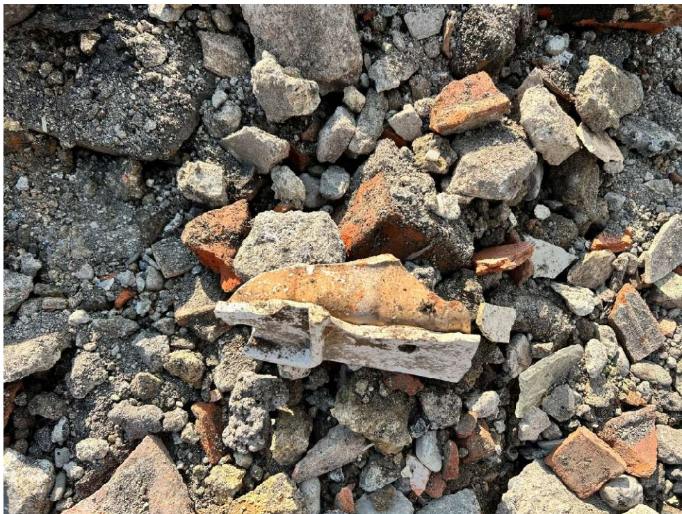
Obrázek 19 Kusy keramických prvků ve stavební suti v KS
